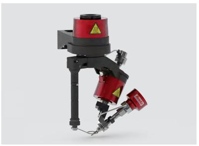
La tête de découpe 2.5D est conçue pour pouvoir couper des pièces chanfreinées à partir de plaques. Deux axes contrôlés par servomoteur sont ajoutés à la tête standard afin de créer une tête cinq axes. Afin de maîtriser la découpe cinq axes, un capteur de hauteur est associé à la tête de découpe.
