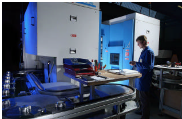
CENTRE D'USINAGE AUTOMATISÉ POUR LA FABRICATION DES EBAUCHES MATRICES
