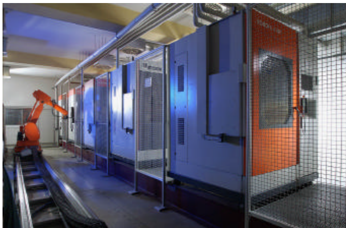
CHAINE ROBOTISÉE D'ELECTRO-EROSION COUPLEE A UN CENTRE DE MESURE TRIDIMENSIONNELLE
