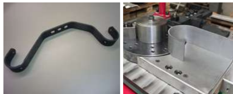
Les profils en tôle hauts et à parois minces peuvent également être pliés comme les pièces épaisses sur la plieuse "radial".
