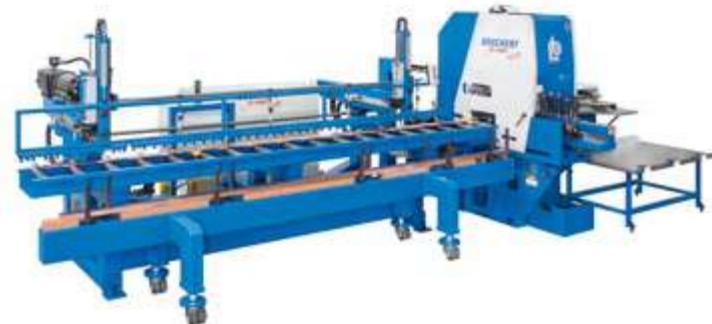
Système de chargement automatique des barres par système à dépression
