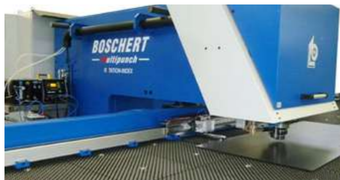
Tête complémentaire sur poinçonneuse pour soudage de goujon
