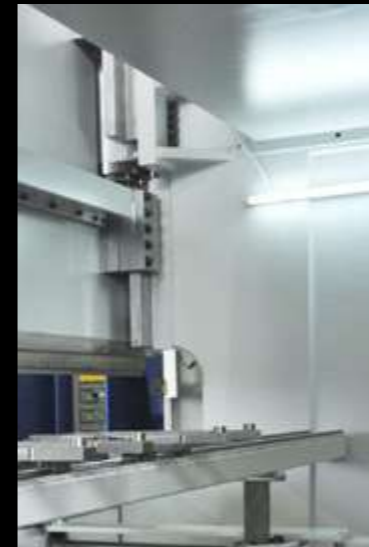
Système de guidage renforcé à glissières pour un mouvement précis et sûr du porte-outils
