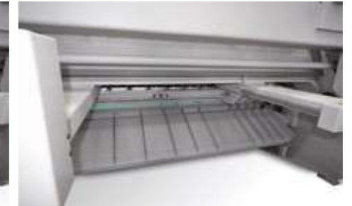
Position 3 : Continue sa descente et inclinaison de 45° pour laisser glisser la tôle vers le sol.
