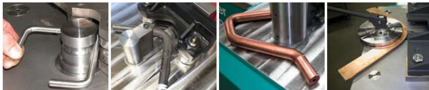
Pliage de tubes en acier sans marquage
