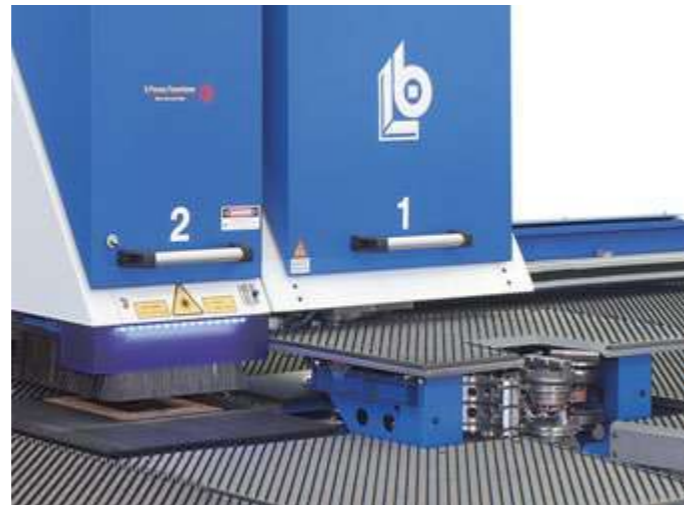
CombiLaser Multipunch avec changeur automatique d'outils
