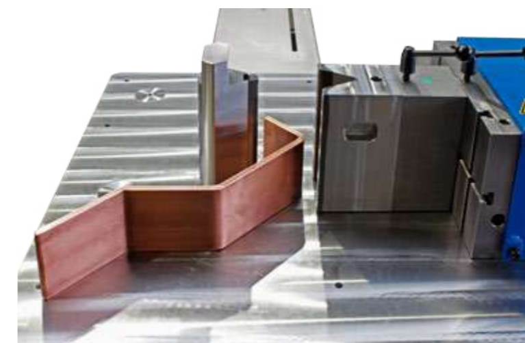
Pliage avec prisme standard et programmation rapide d'angle avec CNC-W.
