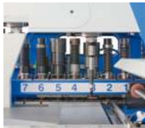
Option taraudage M3 à M16. Il est possible de tarauder jusqu'à 3 Ø différents dans un même cycle sur la machine.
