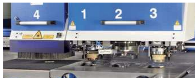
CombiLaser TRI 3 têtes de poinçonnage avec 2 REVOTOOL (Tête 1 & 3) et rotation/Index (tête 2)
