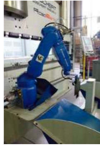
Mesure de l'épaisseur de tôle.
