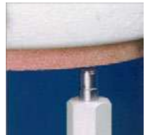
Affûtage de la meule par diamant
