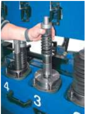
1 à 3 pinces amovibles sont utilisées en fonction de la largeur de la barre.
