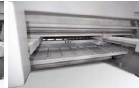
Position 2 : Descente de 100mm en attente de la tôle afin d'éviter qu'elle ne se déforme en tombant jusqu'au sol.
