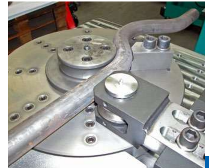
Construction de la table standard avec contre pièce de maintien, entraîneur et axe de pliage.
