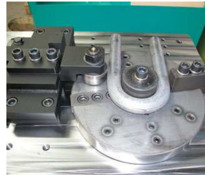
Construction de la table standard avec contre pièce de maintien, entraîneur et axe de pliage.
