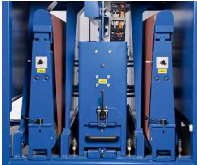
Le fonctionnement interne de TTSC : jusqu'à trois stations de traitement sont disponibles en plusieurs combinaisons.
