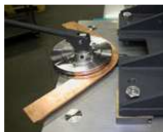
Pliage sur chant avec serre-flan manuel ou hydraulique
