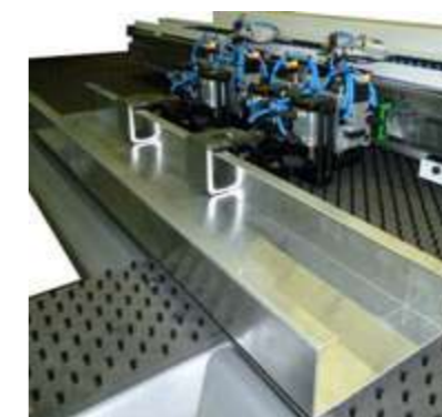
Pinces spéciales pour profils, tôles pliées et tôles ondulées
