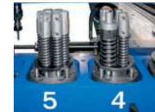
4 ou 6 poinçons par multitool
