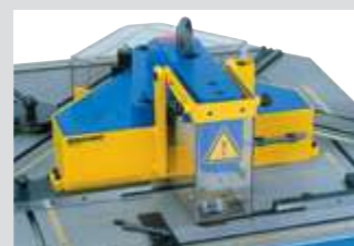
LB 13 / P - poissonage avec outillage TRUMPF
