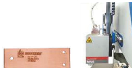
Unité de marquage pour des pièces repérées sur la CU Profi
