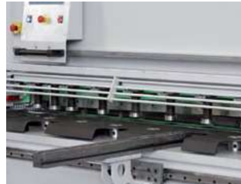
Protection d'accès à la lame avec possibilité d'ouverture pour positionnement de petites pièces.
