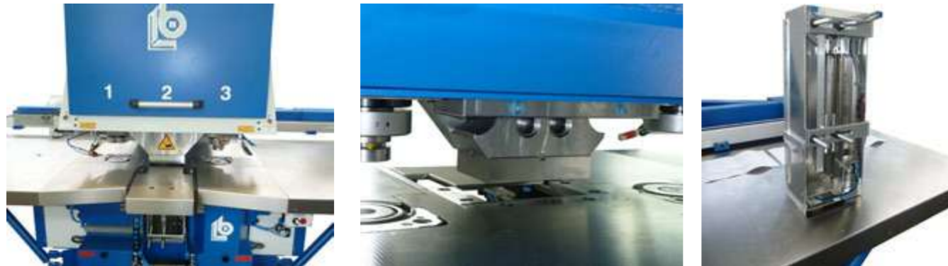
Poinçonneuse avec encochage et station de cisailage 200x300 mm avec unité d'empilage pour les têtes de poinçonnage et d'encochage.
