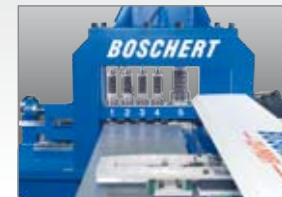
Côté évacuation pièces avec table basculante
